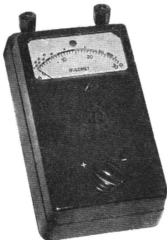
Obr. 161. Nulomet, přístroj k zjišťování účinnosti ochrany nulováním.
