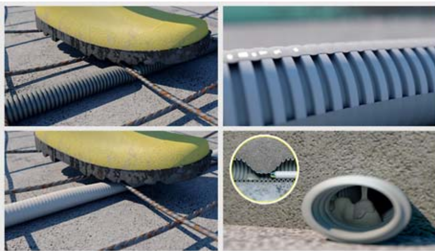
Bild: Das biegsame Highspeed-Rohr »FFKuS-EM-F« ist tritt- und rüttelfest, wobei es lediglich eine normative Verformung von maximal 25% aufweist (vergleiche: links oben einfaches Leerrohr – links unten »FFKuS-EM-F«); die spezielle Außenhaut schützt bei rauen Baustellenbedingungen und verhindert das Eindringen von Betonmilch (rechte Bildhälfte)
