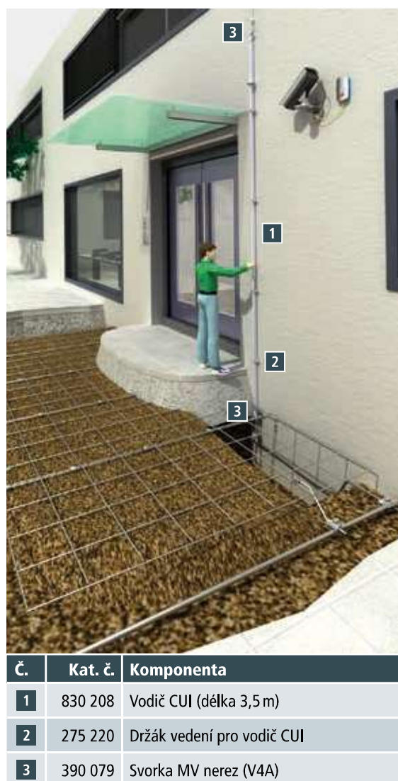
Obr. 4 Ochrana před dotykovým napětím pomocí vodiče CUI
