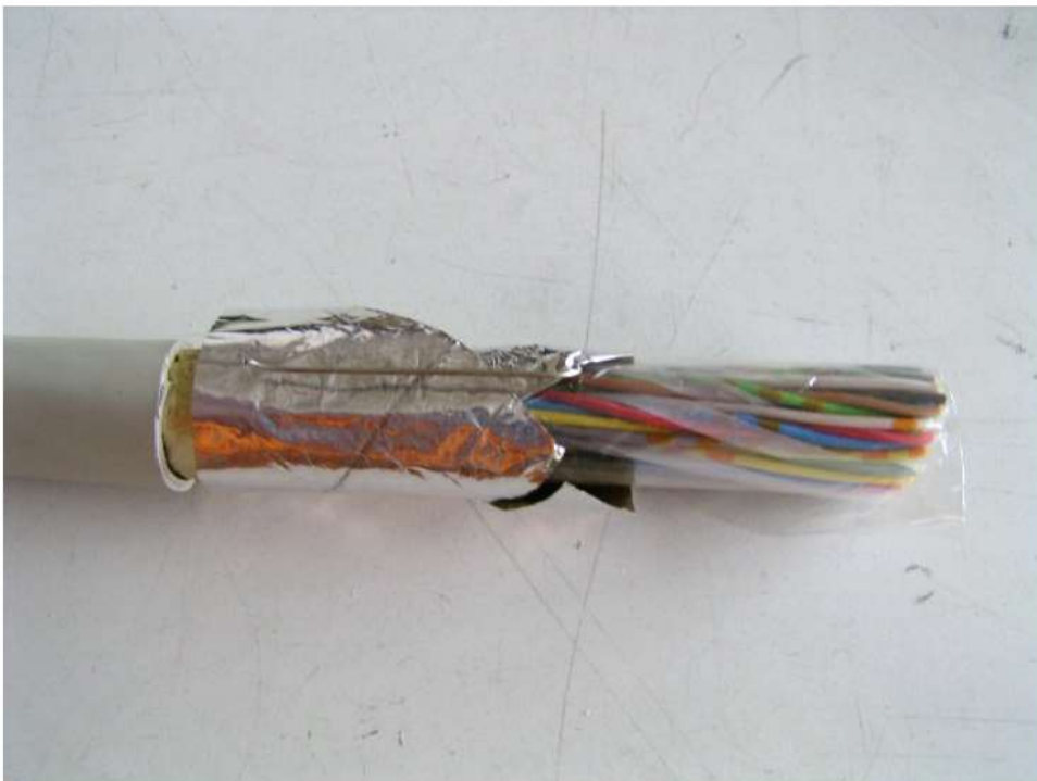
Bild. 4.2: Folie und Beidraht aufmachen und bis ca. zur Hälfte des abisolierten Bereiches zurückschlagen bzw. umlegen.
