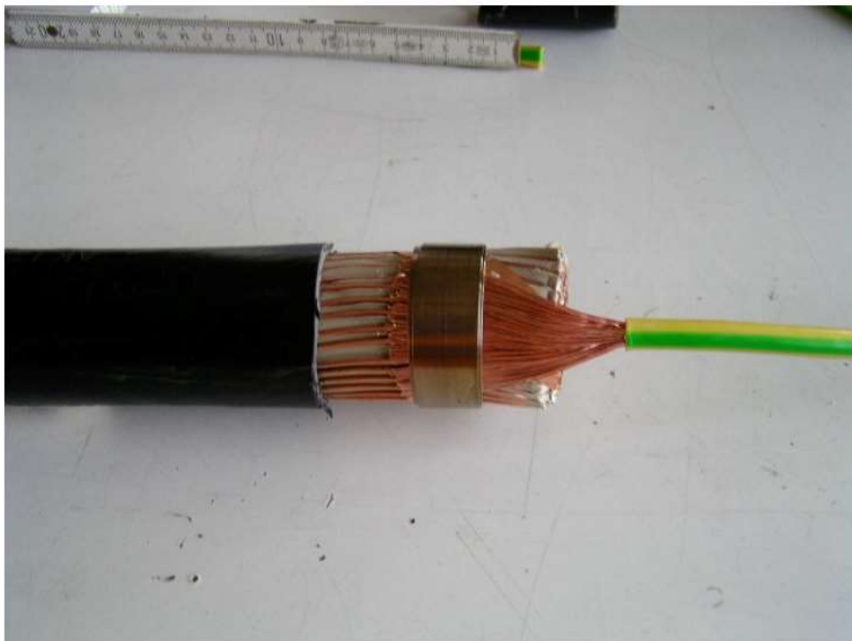
Bild. 1.4: Fertige Montage der Kontakt-Rollfeder.
