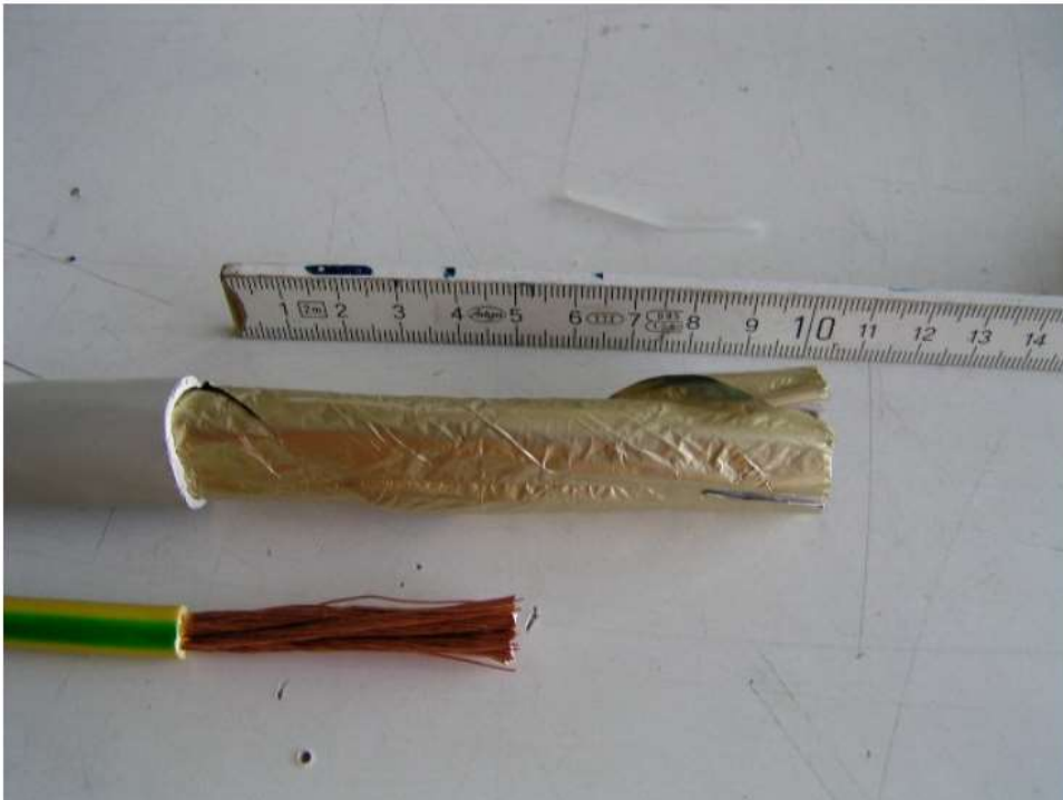
Bild. 4.1: z.B. Kabel JE-Y(ST)Y 40x2x0.8 (für Kontakt-Rollfeder SA KRF 22 V2A ca. 10 cm abisolieren und PE 1x16 mm 2 (mehrdrähtig) ca. 5cm abisolieren.
