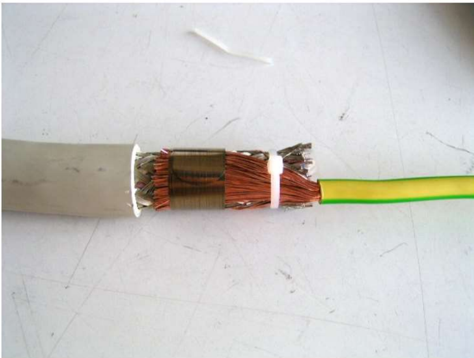
Bild. 3.4: Fertige Montage der Kontakt-Rollfeder evtl. zur besseren Stabilisierung mit Kabelbinder fixieren,
