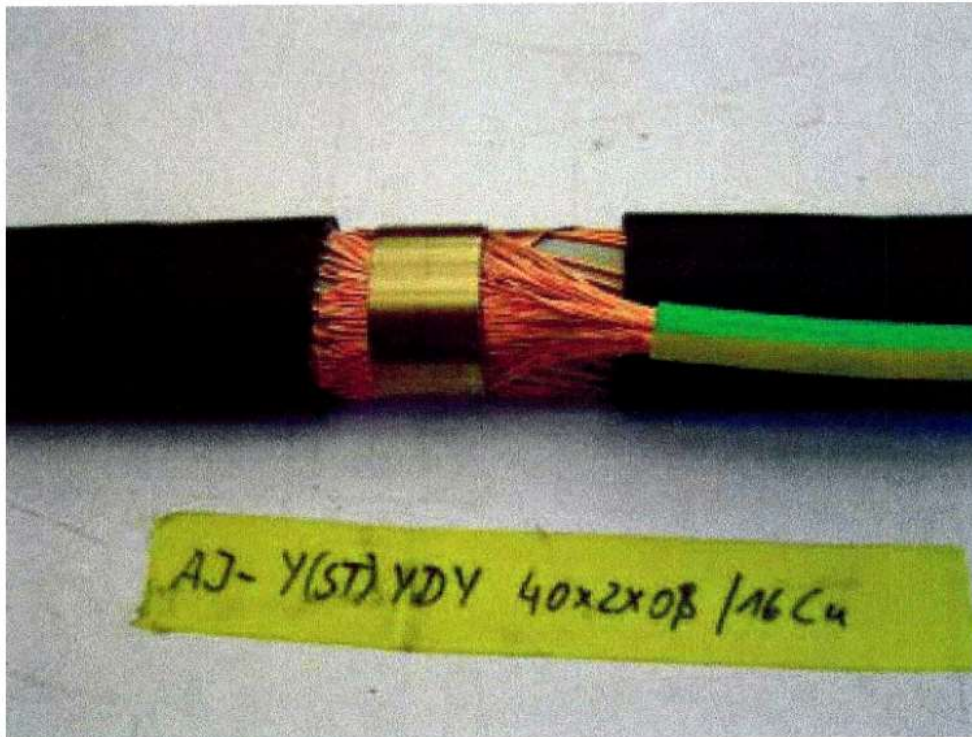
Bild. 2.3: Kontakt-Rollfeder SA KRF 29 V2A um beide Kabel herumwickeln.
