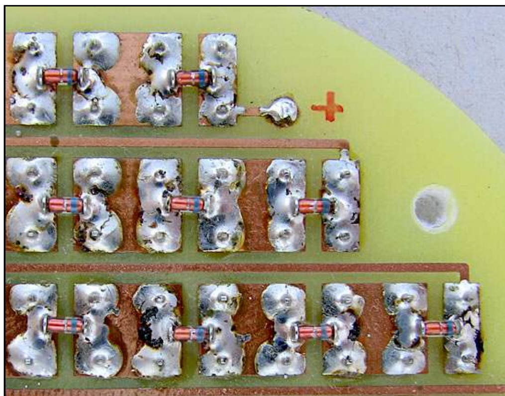
Obr. 5. Zenerovy diody jsou připájeny ze strany spojů
