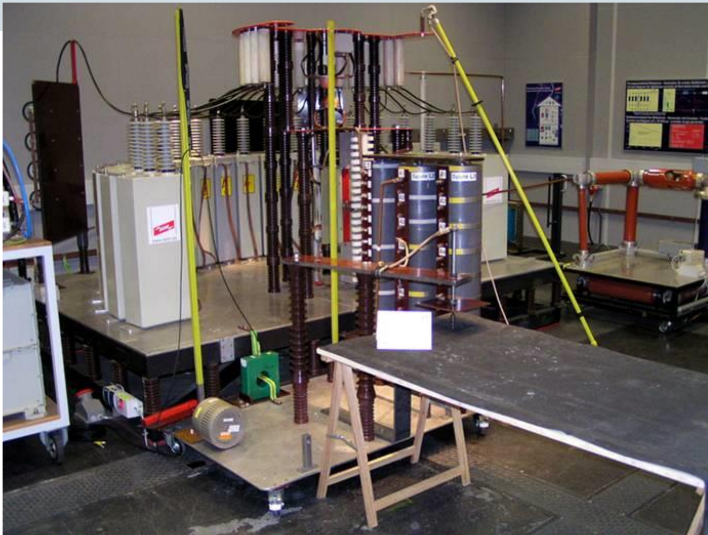
Laboratoř DEHN + SÖHNE: 200 kA 10/350 \mu s
