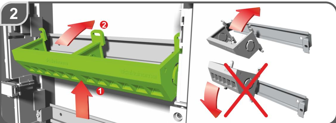
Uchycení na DIN lištu (TS-35). Nejprve je nutné zachytit patchpanel za dolní drážky a poté zacvaknout (je potřeba použít mírné síly) horní části patch panelu na DIN lištu.
