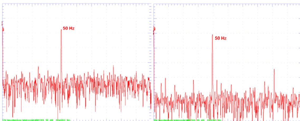
Obr. 22 Srovnání frekvenční analýzy napájecího proudu a mg. pole u dobrého motoru.
