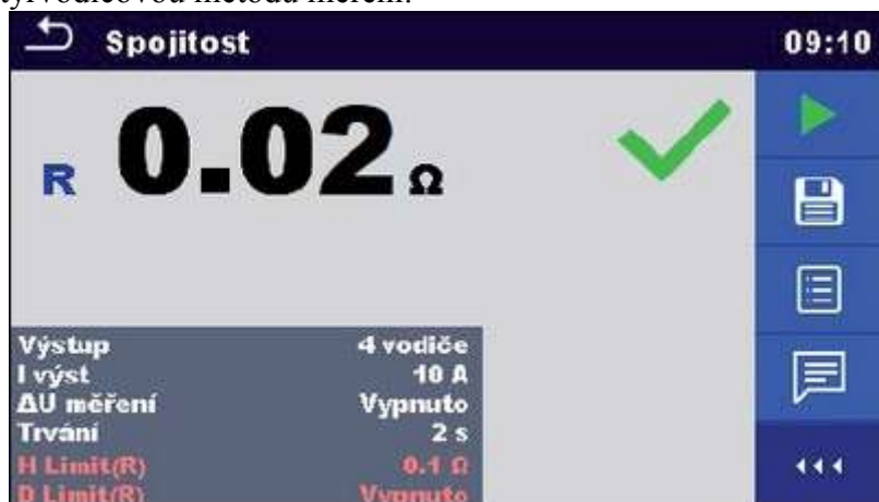
Obr. 6. Ověření spojitosti obvodu PE
