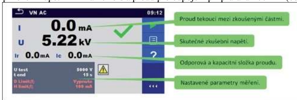
Obr. 5. Ověření vzdušných a povrchových vzdáleností
