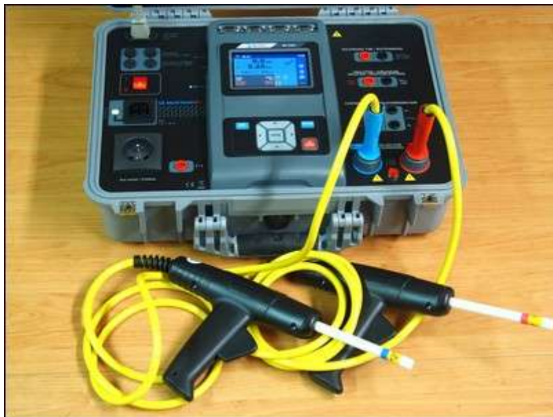
Obr. 8. Sestava přístroje MI 3394 s vn měřicími hroty
