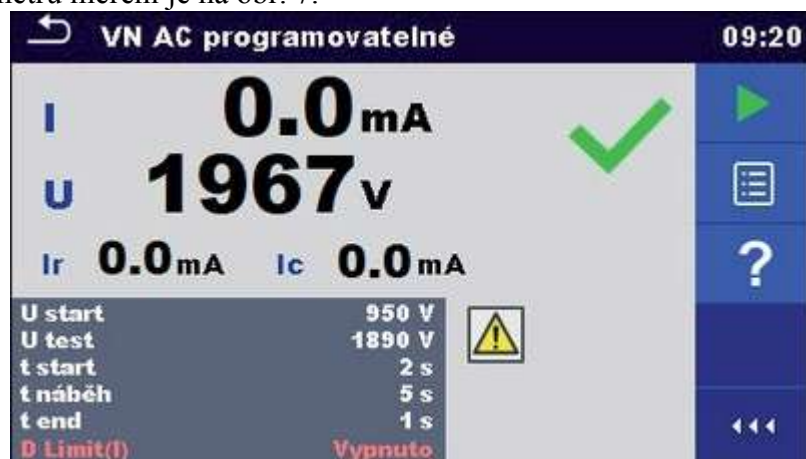
Obr. 7. Měření impulzního výdržného napětí
