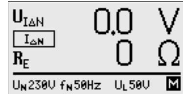
Rovněž zobrazení dotykového napětí podle předpisu bude rovněž 0,0 V, protože v případě jmenovitého vybavovacího proudu 30 mA a společně s tím nízké hodnoty impedance vypínací smyčky bude přiřazeno nízké napětí:
