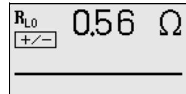
Pokud je rozdíl naměřených hodnot vyšší než je nastaven vyhodnocovací systém přístroje, zobrazí se obě naměřené hodnoty. Rozdílné výsledky měření zobrazené na LCD displeji (1) mohou signalizovat např. napětí na měřeném objektu vzniklé např. termoelektrickým napětím nebo cizím napětím.
