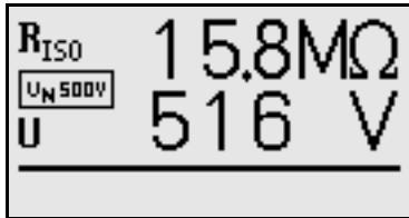
Když je izolační odpor nižší než nastavená limitní hodnota (viz část 12.5) tak se rozsvítí signálka  $U_L/R_L$ (7)
