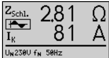
U třífázových zařízení se nesmí zapomenout provést měření impedance vypínačí smyčky vždy ve všech třech fázích (L1, L2, a L3) proti ochrannému vodiči PE.
