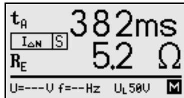
Při opětovném krátkodobém stisknutí tlačítka  $I_{\Delta N}$  (2 nebo 18) se zobrazí údaje předchozí zkoušky, t.j. údaje dotykového napětí a zemního odporu chráničového zemniče. Cyklus je možné podle potřeby opakovat.
