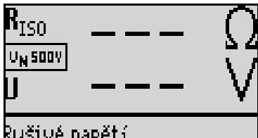
Jednotlivé vodiče (L1, L2, L3 a N) se musí měřit proti vodiči PE!
