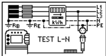
Elektroměr se zkouší pomocí interního zatěžovacího odporu přístroje. Po stisku tlačítka Start (3) můžete během následujících 5 vteřin přezkoušet správný náběh elektroměru. Musí se postupně přezkoušet jedna fáze po druhé proti vodiči N.
