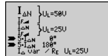
Čas vybavení se musí pohybovat mezi 10 ms (minimální čas zpoždění vybavení proudového chrániče typu GI) a 40 ms.
