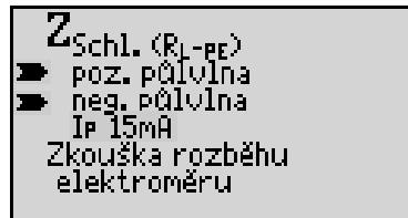
Zda se má měřit s kladnou nebo zápornou půlvlnou závidí od polarity předmagnetizačního stejnosměrného proudu tohoto "předřadníku". Když při použití kladné půlvlny proudový chránič vybaví, je třeba použít měření se zápornou půlvlnou.
