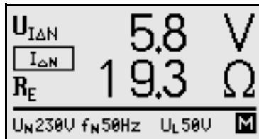
Jestliže je dotykové napětí měřené proudem 1/3 jmenovitého vybavovacího rozdílového proudu a přepočítané na proud  $I_{\Delta N}$  vyšší než t.j.  $U_{I\Delta N} > 50 \text{ V} (> 25 \text{ V})$ , pak signálka  $U_L/R_L$  (7) svítí červeně.
