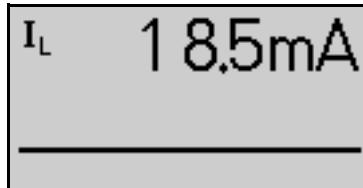
Poloha přepínače na klešt'ovém měřicím transformátoru proudu musí odpovídat zvolenému měřicímu parametru  $I_L$  nebo  $I_{AMP}$  na displeji měřicího přístroje.
