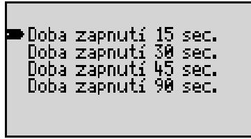
Předvolená doba zapnutí přístroje výrazně ovlivňuje kapacitu baterií.
