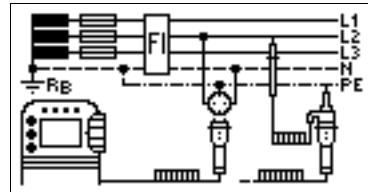
Proudový chránič může být používán pouze v sítích TN-S. V sítích TN-C nebude proudový chránič fungovat, když není vodič PE veden mimo proudový chránič, nýbrž je na zásuvku veden společně s vodičem N. Tak bude chybový proud téci proudovým chráničem zpět a nevznikne tak žádny rozdílový proud, který by způsobil vybavení proudového chrániče.
