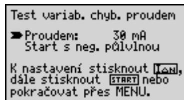
Každým stiskem tlačítka  $I_{\Delta N}$  / i se hodnota proudu zvýší o 1 mA. Při trvalém stisku tohoto tlačítka se proud zvyšuje automaticky plynule. Po několika vteřinách se rychlosť změny zvýší. Když potřebujete nastavenou hodnotu např. snížit, držte tisknuté tlačítko  $I_{\Delta N}$  / i a stiskněte současně opakovánou nebo trvale tlačítko Menu. Když dosáhnete požadovanou hodnotu zkušebního proudu, tak se může stiskem tlačítka Start provést zkouška jak je popsáno v části 7.1.
