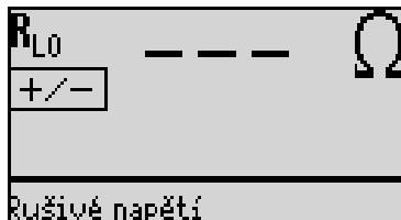
K nalezení chyby měřte odpory v obou polaritách měření.
