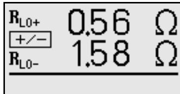
K těmto výsledkům lze dospět zejména v zařízeních s ochranou odpojením bez samostatného ochranného vodiče (dříve nulováním). Důvodem mohou být v tomto případě paralelně připojené impedance nebo vyrovnávací proudy. Dále mohou mít vliv odpory, jejichž hodnota se v průběhu měření může měnit (např. indukčnosti) nebo také nedokonalý kontakt při měření (dvojí zobrazení hodnot na displeji).
