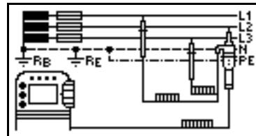
K měření použijte výměnný adaptér dvojpólový (12) do kterého připojíte další šnúru s měřicím hrotem a tím rozšíříte adaptér na trojpólový.
