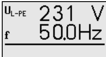
Stiskem tlačítka  $I_{\Delta N}$  / i přepínáte zobrazení obou ostatních napětí zjistitelných v zásuvce. Zpět k předchozímu zobrazení se dostanete stiskem tlačítka Start.
