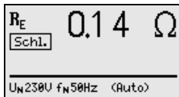
Vezmeme-li za základ stejný průřez vodičů L a N, tak můžeme orientačně odpor fázového vodiče uvažovat v poloviční hodnotě vnitřní impedance sítě  $Z_l$  (měřeno mezi fázovým a středním vodičem).
