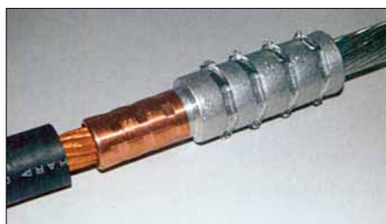
Obr. 1. Nevhodná lisovací vložka a/nebo neodborně provedené lisování vedou k nadměrným lisovacím tlakům (vpravo) nebo k nedostatečným lisovacím tlakům (vlevo)
