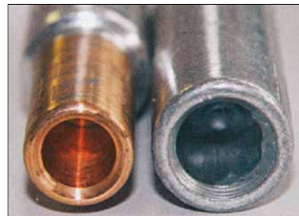
Obr. 8. Hliníková strana (vpravo) má zpravidla větší průměr než měděná strana (vlevo) z důvodu vyrovnání horší vodivosti hliníku
