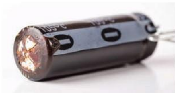
Obr. 1 Elektrolytický kondenzátor s otevřeným ventilem a unikajícím elektrolytem (zdroj: Shutterstock – Roman Pyshchuk)
