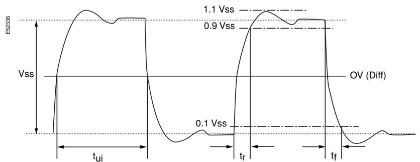
$$V_{ss} = |V_t - V_{t^*}|$$
