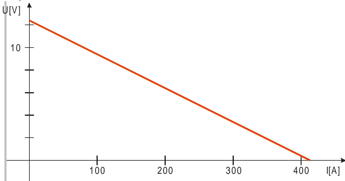
**Dodatek:** Parametry předchozího zdroje odpovídají automobilové baterii. Při startování automobilu musí baterie dodávat velký proud, proto je třeba, aby její vnitřní odpor byl co nejmenší.
