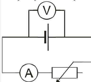
Reostatem (proměnným odporem) měníme velikost odporu zapojeného v obvodu a tím i velikost proudu. Napětí na svorkách baterky měříme voltmetrem.
