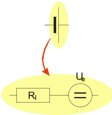
**Př. 2:** Jak zařazení sériového vnitřního odporu vysvětluje pokles svorkového napětí při zvýšení odebíraného proudu?
