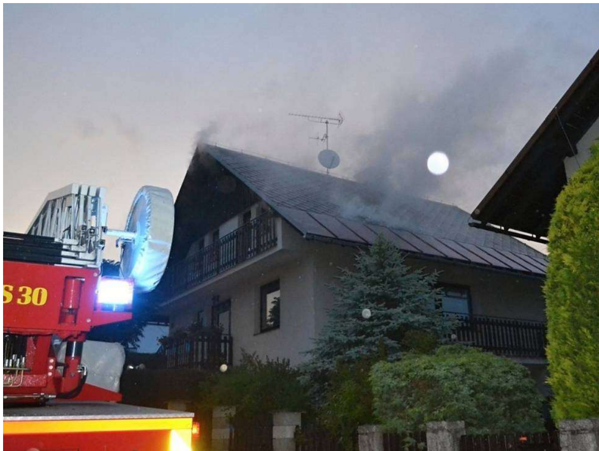
Obr. 3a. Požár střechy rodinného domu po úderu blesku do hromosvodu se špatně nainstalovanými TV anténami.
