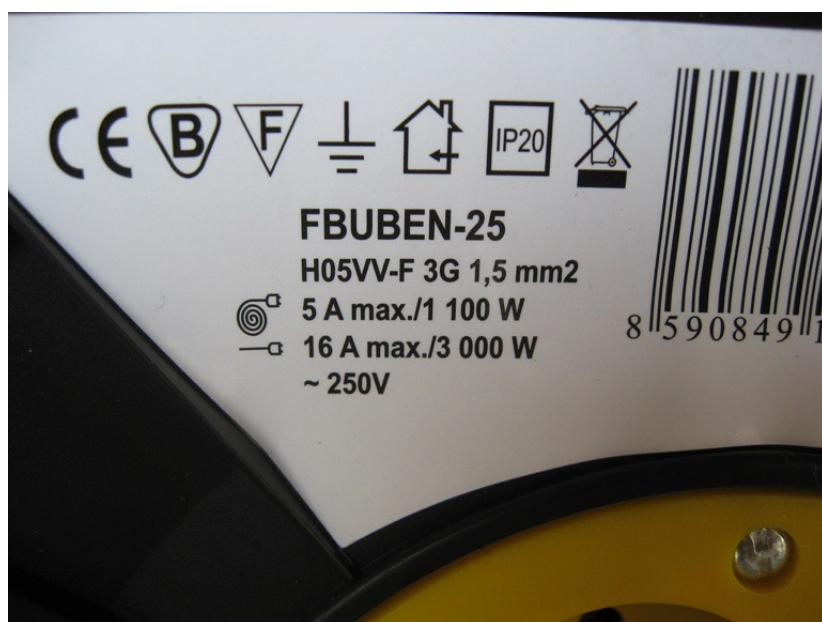
Obr. 2 Technické údaje prodlužovacího přívodu na štítku kabelového navijáku
