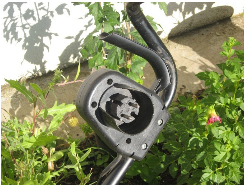
Obr. 1 Vidlice elektrického předmětu pro připojení prodlužovacího přívodu jednonásobnou pohyblivou zásuvkou
