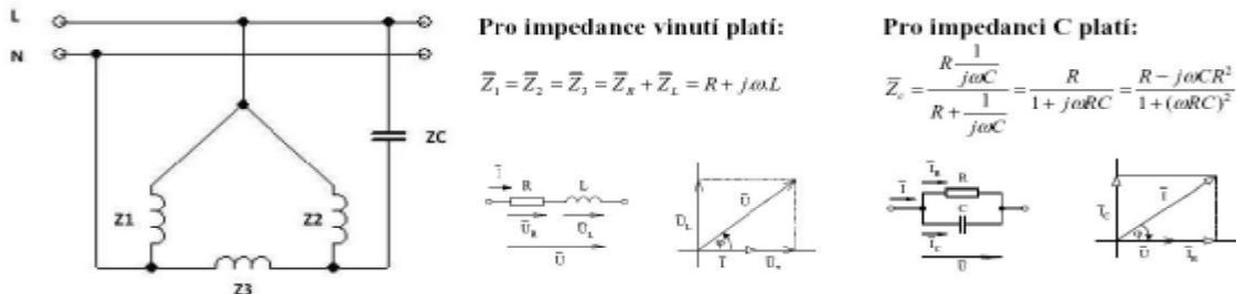
platí, že s rostoucí kapacitou se impedance  $|\bar{Z}_c|$  snižuje a  $\varphi_{\bar{Z}_c}$  zvyšuje. Paralelní spojení  $\bar{Z}_c \parallel \bar{Z}_2$  se dostává do rezonance dle podmínky:
